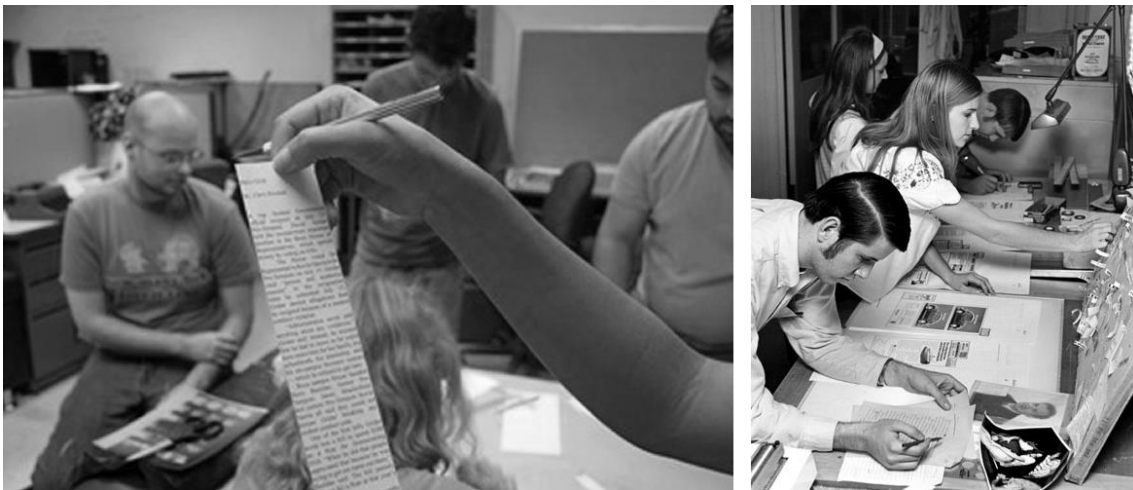
Figura2. A imagem mostra uma fotocomposição já recortada e o setor de montagem de páginas. O montador faz as páginas seguindo o layout do diagramador, o processo é bem artesanal
