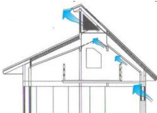
Figura 4: Sistema de convecção natural de ar através de forro angulado, persiana solar e clarabóia são aplicações do princípio de Bernoulli e efeito Venturi na CasaE-UFRGS.
