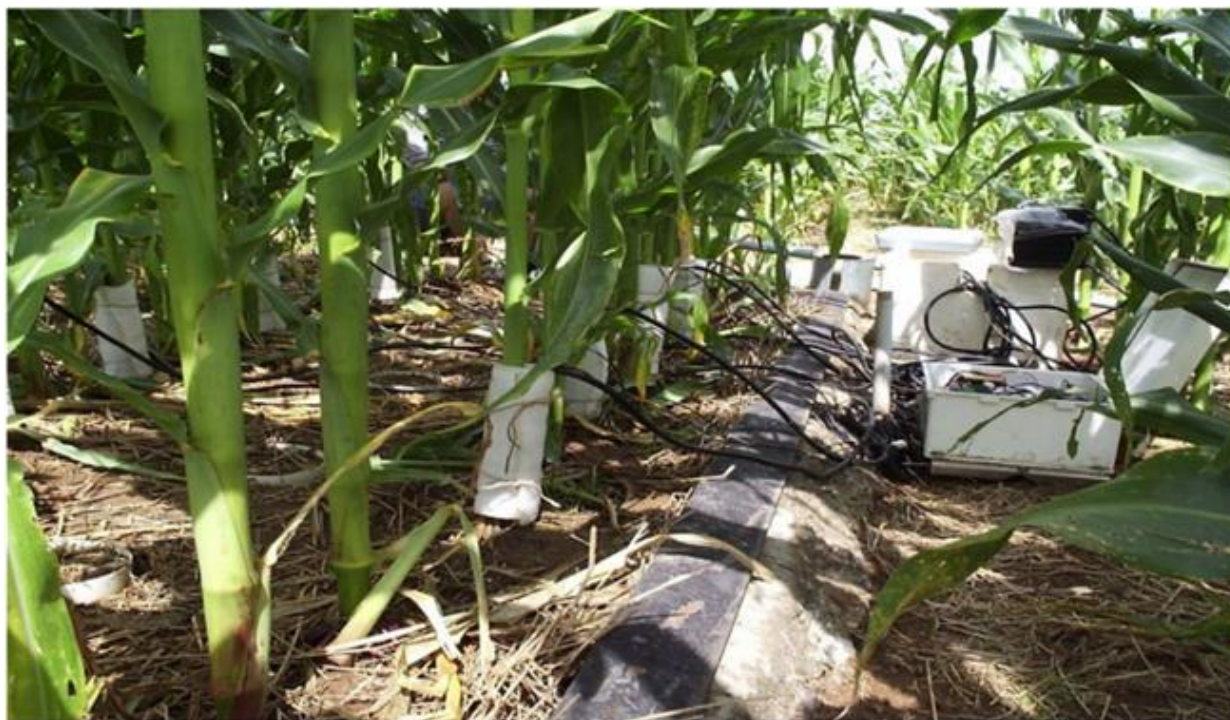
Figura 4. Lisímetro de pesagem destinado a medir a evapotranspiração de culturas, instalado em 1988, na Estação Experimental Agrônômica da UFRGS. Foto do autor.
