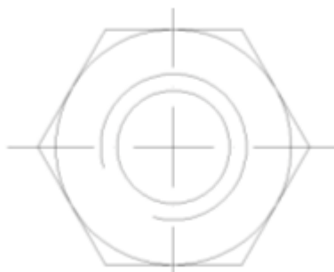
Figura 44 – Representação de uma porca sextavada com rosca interna no furo (sem o parafuso)
