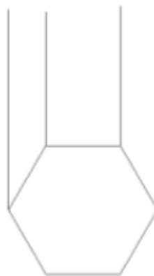
Figura 33 – Alinhamentos verticais do canto da porca para desenhar a vista anterior
