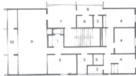
10 1 – Hall 2 – Gabinete 3 – Banho 4 – Dormitórios 5 – Closet 6 – Área de Serviço 7 – Cozinha 8 – Dormitório de Serviço 9 – Sala 10 – Varanda Edifício FAM - Planta baixa, pavimento-tipo. MIZOGUCHI & XAVIER, 1987
